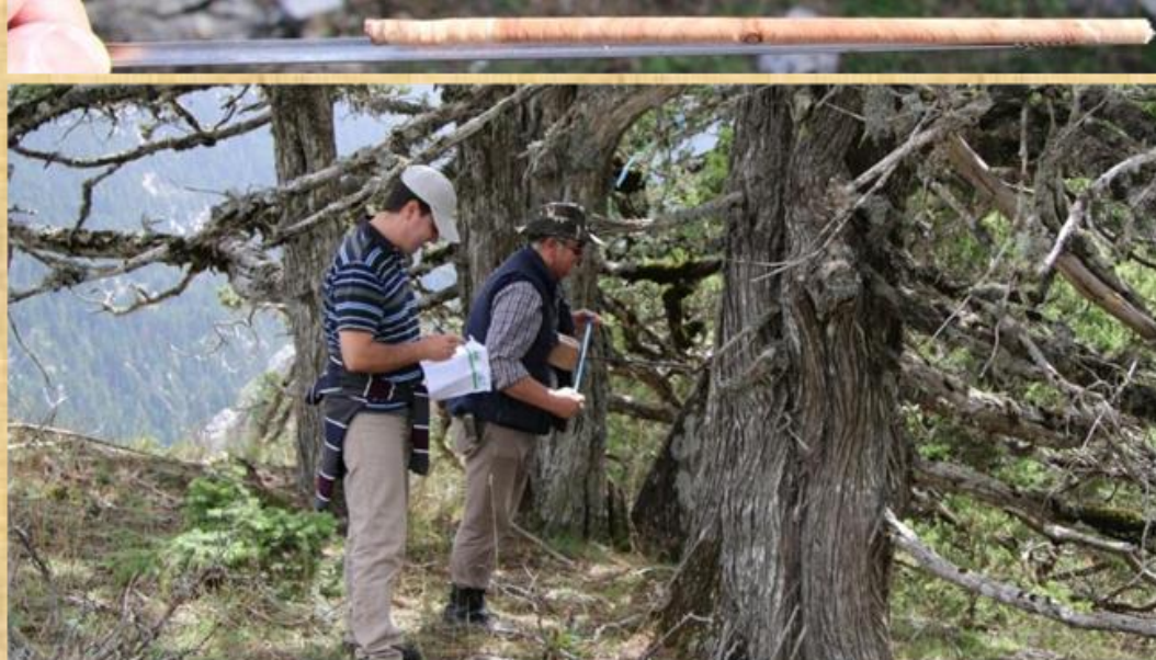
Εικόνα 9: Δείγμα τρυπανιδίου (πάνω) και διαδικασία εξαγωγής τρυπανιδίου από μεγάλης ηλικίας δένδρο στην περιοχή Φακίτσα(Γ. Μάντακας, Σεπτέμβριος 2014).
